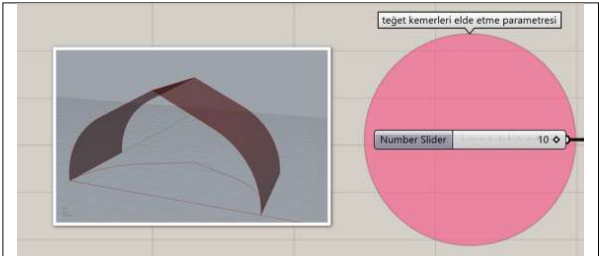
Şekil 13. Sayı kaydırıcısındaki değerler değiştirilerek oluşan iki farklı iki merkezli sivri kemer örneğidir.
